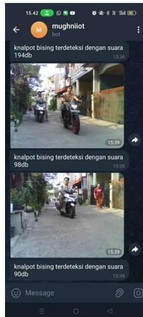
Gambar 8. Pengujian knalpot bising pada siang hari.
