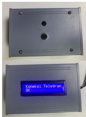
Gambar 10. Box Penyimpanan alat pendeteksi suara tampak depan dan belakang
