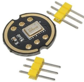
Gambar 3. Sensor suara INMP441 [Sumber: Shah M.A. (2019)]
