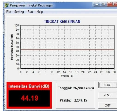
Gambar 6. Kalibrasi Alat SLM
